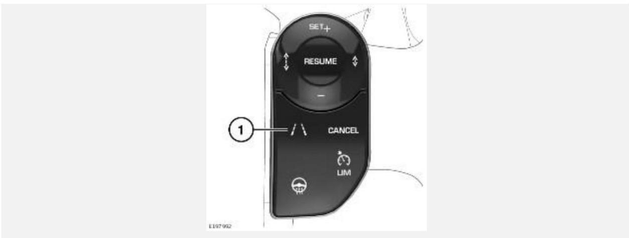
Для включения или выключения системы нажмите кнопку (1), расположенную на рулевом колесе. Для подтверждения статуса системы подсвечивается пиктограмма на кнопке.
