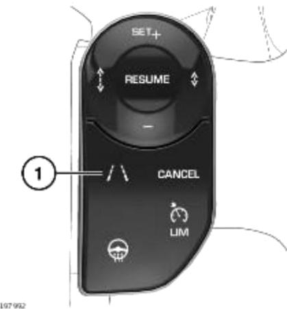
Для включения или выключения системы нажмите кнопку (1), расположенную на рулевом колесе. Для подтверждения статуса системы подсвечивается пиктограмма на кнопке.
