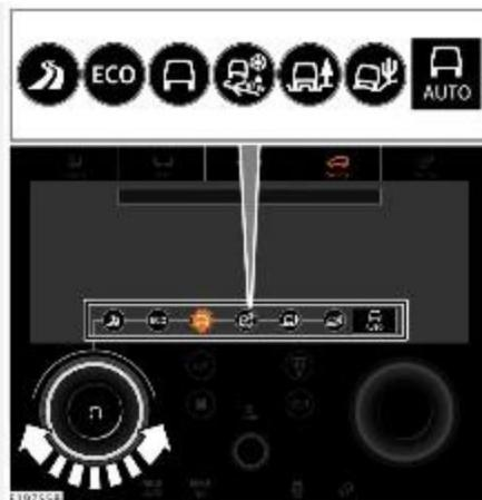
Поверните переключатель со стороны водителя для прокрутки и выбора необходимой программы системы адаптации к дорожным условиям Terrain Response. Или коснитесь соответствующей пиктограммы на экране. В качестве подтверждения включения программы движения системы адаптации к дорожным условиям Terrain Response загорается пиктограмма соответствующего режима. На панели приборов и поворотном переключателе также отображается пиктограмма.
