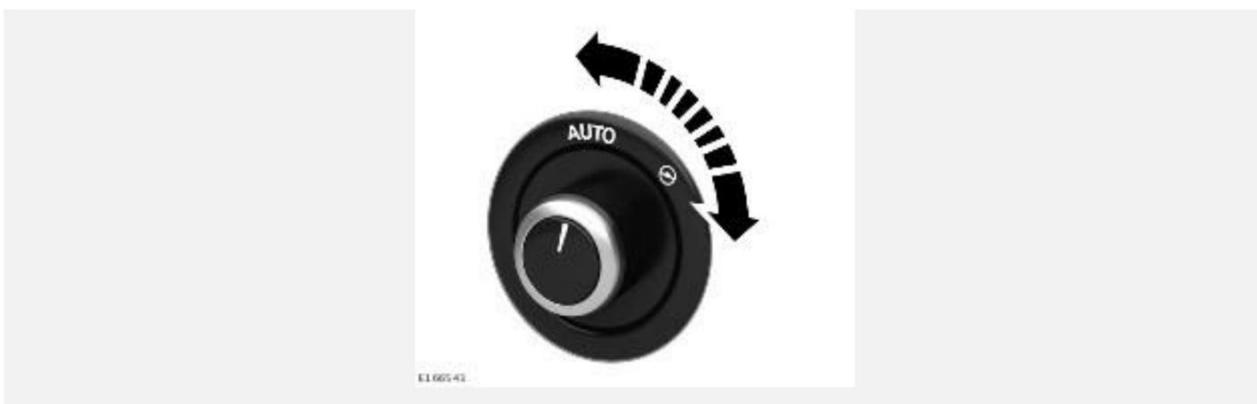
Когда переключатель регулировки положения рулевой колонки находится в положении режима **AUTO** (Авто), рулевая колонка будет перемещаться для облегчения посадки в автомобиль и выхода из него.
