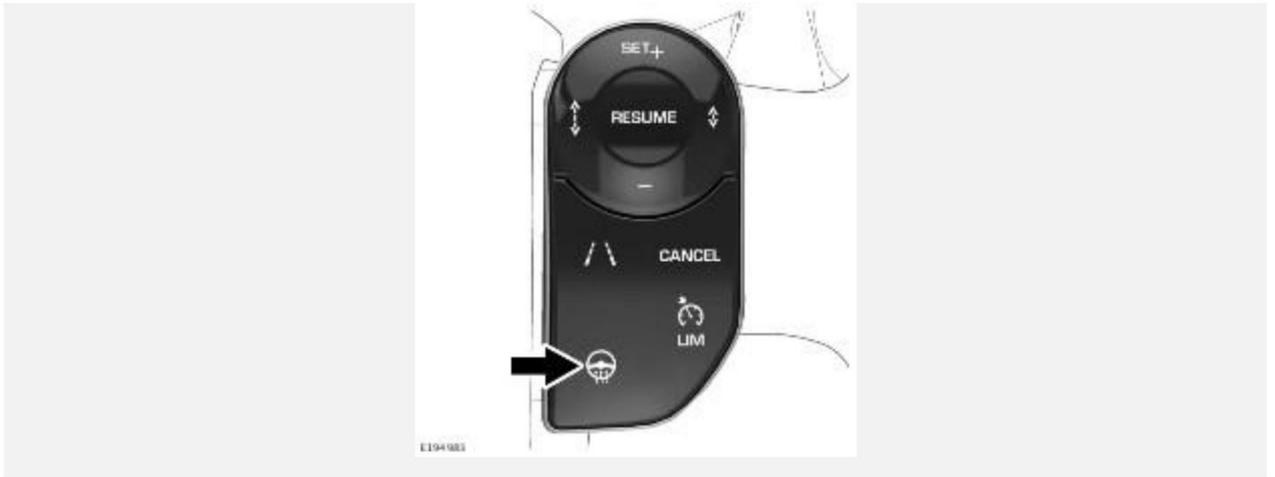
Для включения подогрева рулевого колеса нажмите на указанную кнопку. Нажмите еще раз для выключения.
