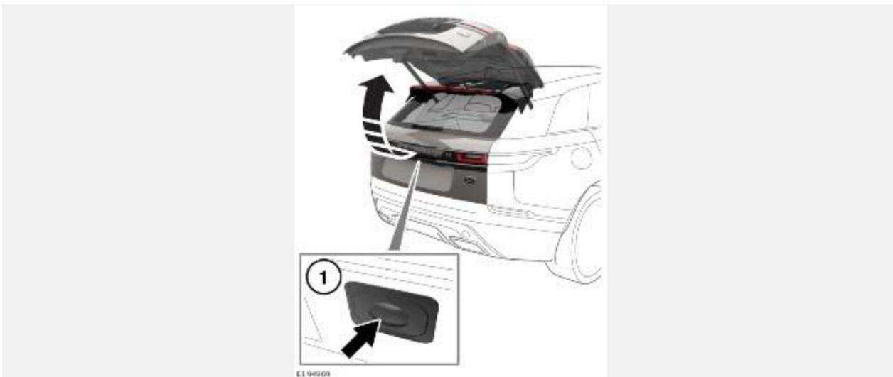
1. Наружная кнопка открывания двери багажного отделения: нажмите, чтобы отпереть дверь, затем потяните вверх, чтобы открыть.
