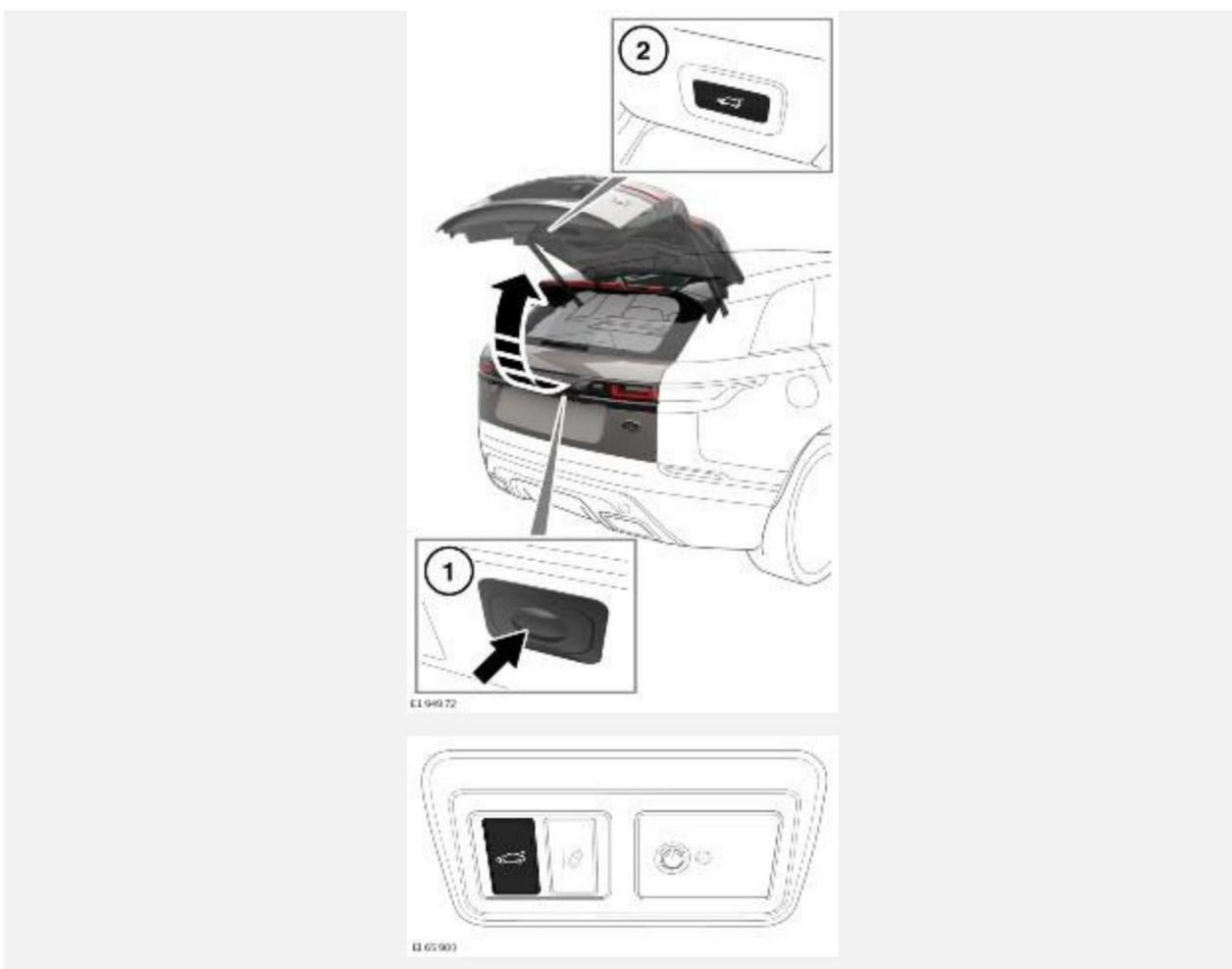
Чтобы задействовать дверь багажного отделения с электроприводом:
