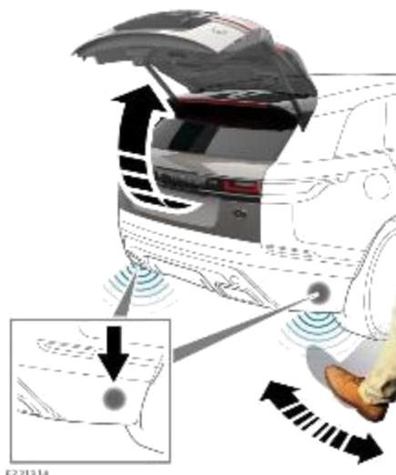
Датчики (при наличии) расположены в наружной части заднего бампера. Датчики распознают движение ноги ниже уровня бампера и обеспечивают автоматическое открывание или закрывание двери багажного отделения с электроприводом.
