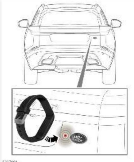
Зажигание должно быть выключено. После выхода из автомобиля и закрывания последней открытой двери антенна электронного ключа-браслета активируется на 30 секунд. Пользователю за это время необходимо приложить электронный ключ-браслет к антенне, расположенной слева от овальной эмблемы Land Rover на двери багажного отделения. Когда безопасное соединение установлено, автомобиль запирается и включается сигнализация.
