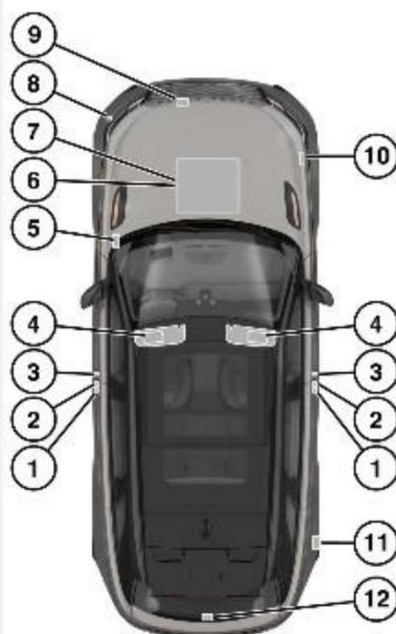
1. Табличка с указанием данных о массе автомобиля и идентификационного номера автомобиля (VIN): расположена у основания стойки "В" со стороны водителя. Там же расположена табличка с указанием даты выпуска автомобиля (только для автомобилей, предназначенных для продажи в Австралии). Номер VIN можно также отобразить на панели приборов через меню **Vehicle info** (Информация об автомобиле) и **Vehicle VIN** (VIN автомобиля). См. [МЕНЮ ЩИТКА ПРИБОРОВ](#).
