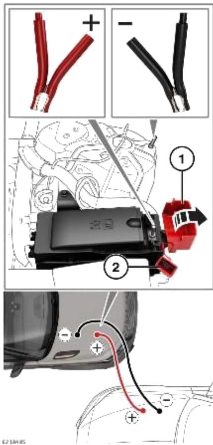
Откройте капот и найдите блок предохранителей моторного отсека. См. [РАСПОЛОЖЕНИЕ БЛОКОВ ПРЕДОХРАНИТЕЛЕЙ](#).
