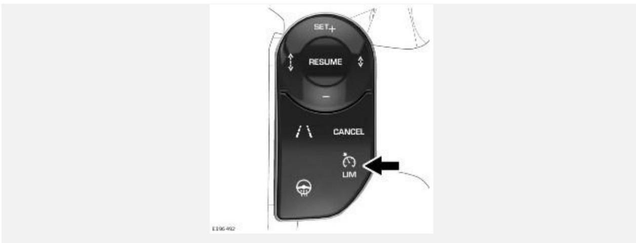
Для включения функции ограничителя скорости нажмите кнопку **LIM** (Ограничитель) на рулевом колесе.
