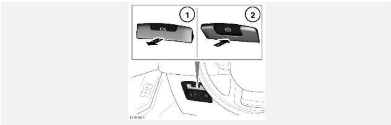
Переключатель электрического стояночного тормоза (EPB) расположен на блоке переключателей между рулевым колесом и дверью водителя. Переключатель используется следующим образом:
