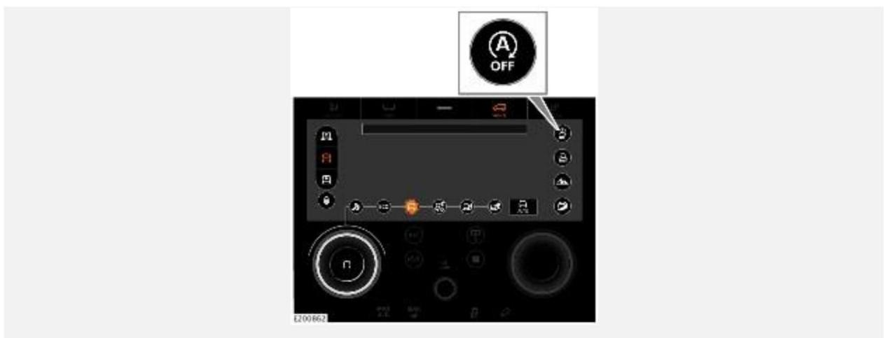
Коснитесь пиктограммы **A OFF** ("A" выкл.) на нижнем сенсорном экране, чтобы отключить автоматическую интеллектуальную систему запуска/остановки двигателя "Стоп/Старт".
