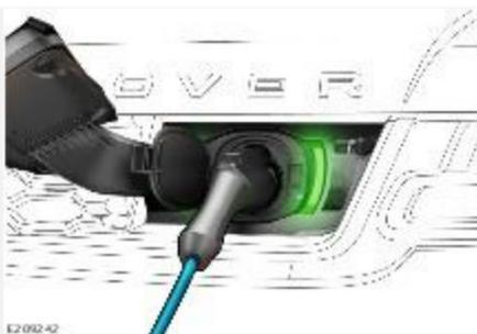
Ряд светодиодов с каждой стороны разъема для зарядки информируют пользователя о состоянии зарядки. В определенных условиях светодиоды загораются белым цветом, чтобы облегчить подключение кабеля в темноте.
