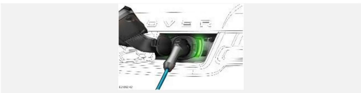
Ряд светодиодов с каждой стороны разъема для зарядки информируют пользователя о состоянии зарядки. В определенных условиях светодиоды загораются белым цветом, чтобы облегчить подключение кабеля в темноте.
