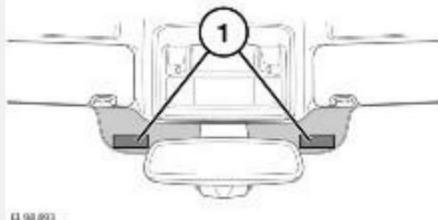
Атермальное ветровое стекло такого типа фильтрует солнечный свет, пропуская его через специальный слой внутри стекла.
