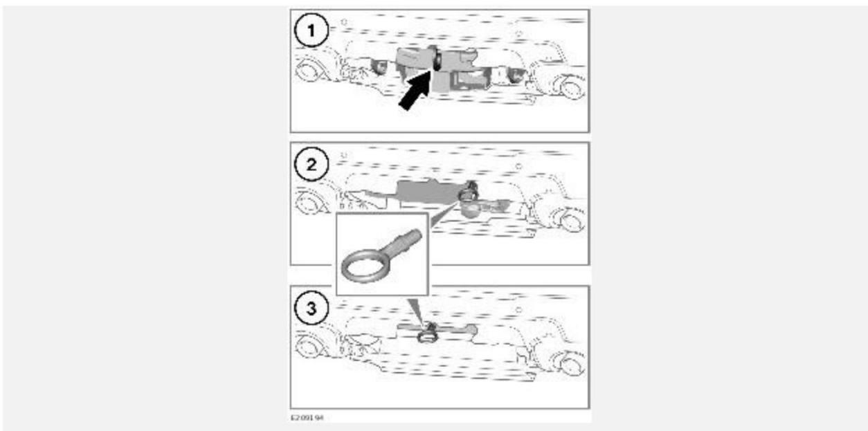
Задняя точка крепления буксировочной проушины расположена в заднем бампере и закрыта съемной панелью.
