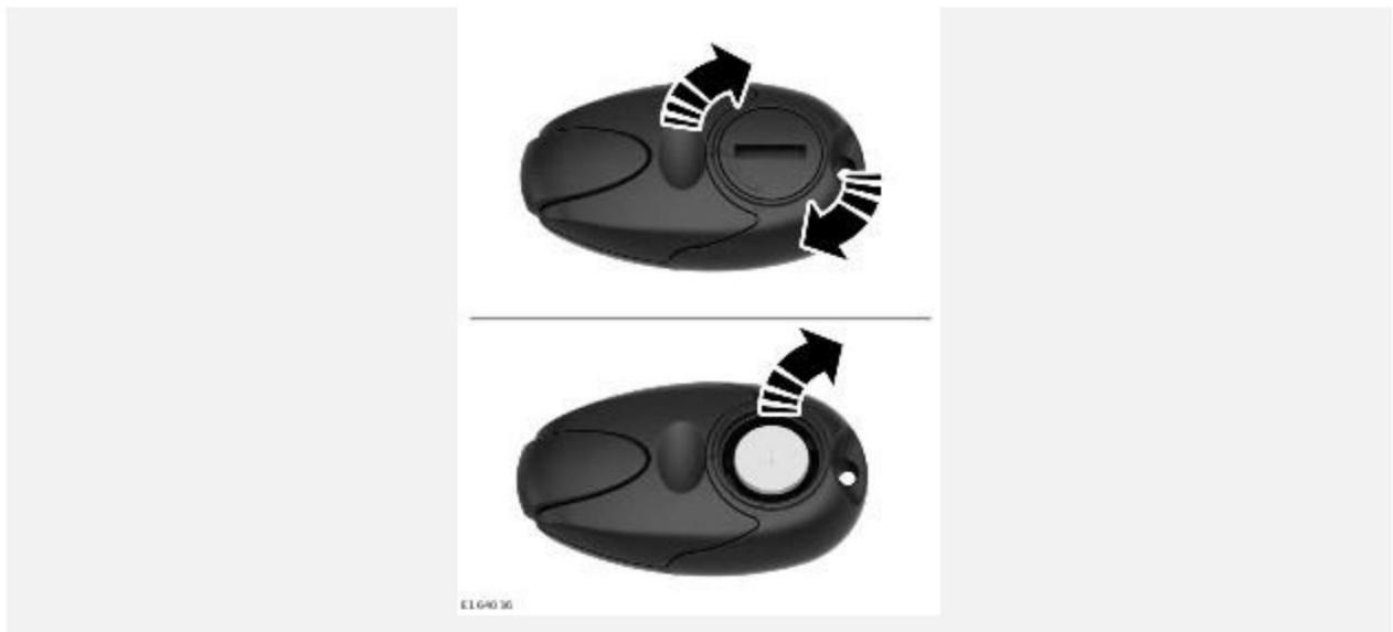
Перевернув пульт дистанционного управления задней стороной вверх, с помощью монеты или аналогичного предмета поверните крышку батарейного отсека. Снимите крышку. Под ней находится батарейный отсек. Извлеките старый элемент питания и, соблюдая правильную полярность, установите новый элемент питания CR1/3N с напряжением 3,3 В. Установите на место крышку и поверните ее, чтобы закрыть до фиксации.
