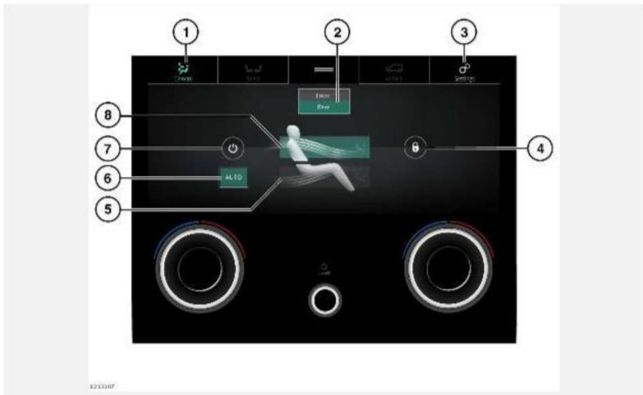
Для доступа к экрану **Rear Climate** (Климат-контроль в задней части салона) коснитесь пиктограммы **климат-контроля** на нижнем сенсорном экране. См. [ОРГАНЫ УПРАВЛЕНИЯ НА НИЖНЕМ СЕНСОРНОМ ЭКРАНЕ](#).
