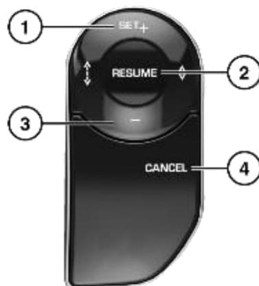
При включенной системе АТРС можно задать и отрегулировать целевую скорость автомобиля. Используйте кнопки управления, расположенные с правой стороны рулевого колеса.
