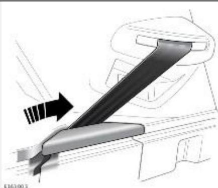
Крышку багажного отделения можно использовать, даже если ремни безопасности сидений третьего ряда по-прежнему присоединены ко внешним замкам.
