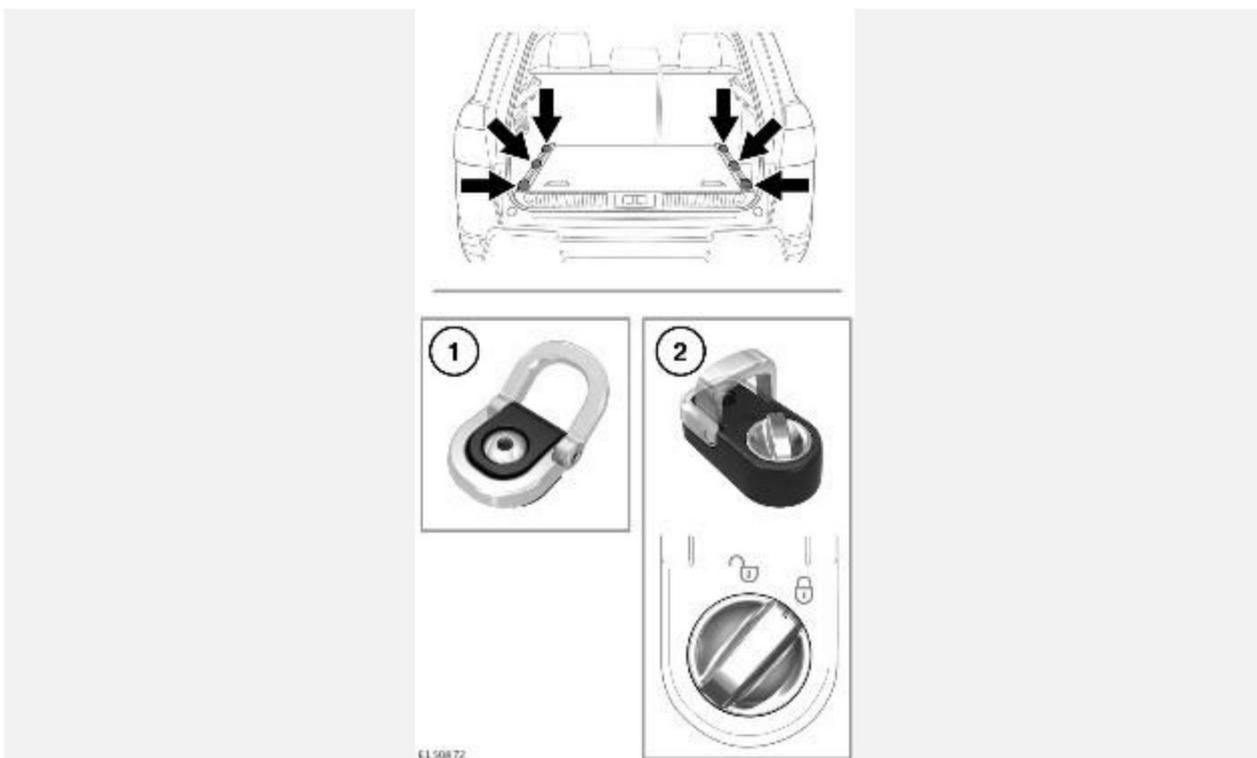
1. В задней части панели пола багажного отделения находятся шесть ползунков, помогающие надежно закрепить крупный багаж.
