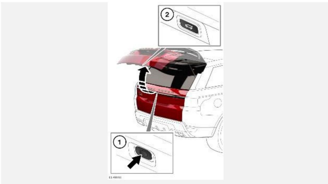
Чтобы задействовать дверь багажного отделения с электроприводом:
