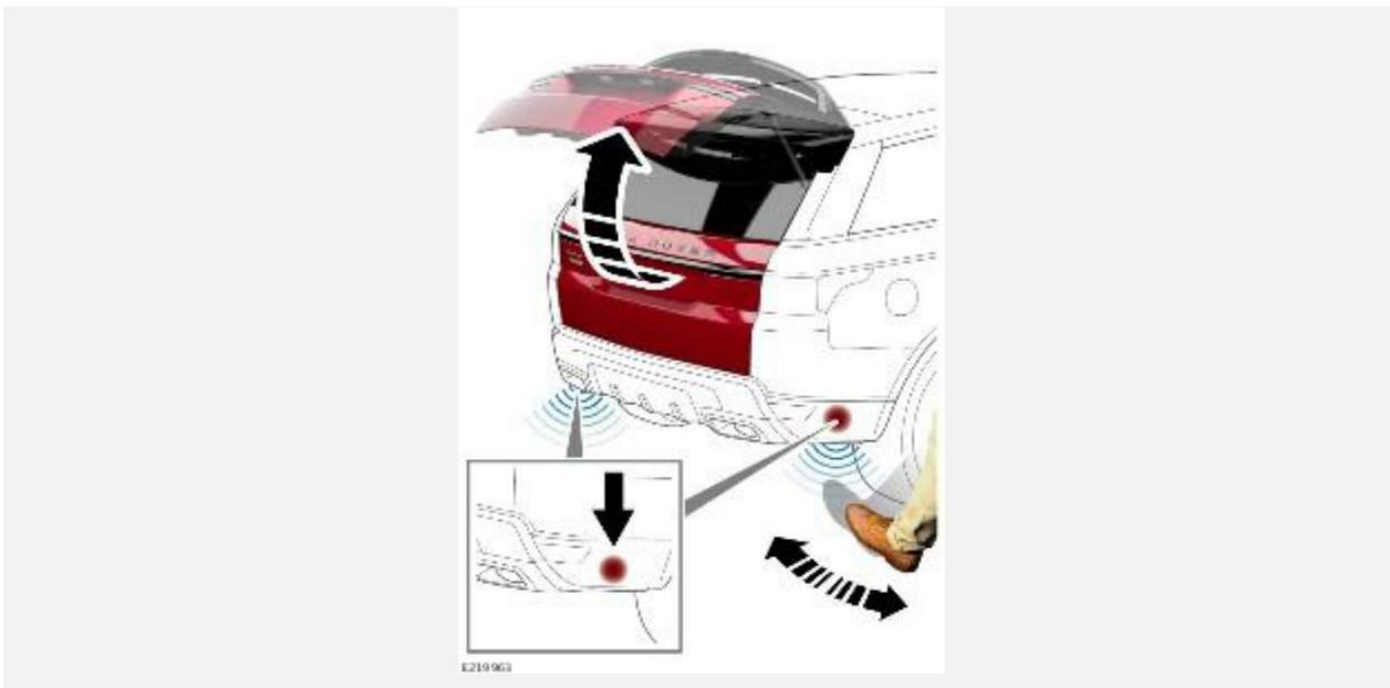
Чтобы активировать сенсорное бесконтактное открывание двери багажного отделения (движением ноги) подойдите к автомобилю и совершите плавное движение ногой в прямом и обратном направлении. Движение ноги должно быть выполнено в течение 1-2 секунд в пределах одной из двух зон чувствительности датчиков автомобиля, как показано на рисунке. Как только автомобиль распознает движение, мигнут указатели поворота, и дверь багажного отделения сработает.
