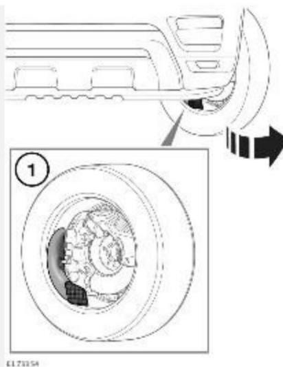
Передние колеса автомобилей SVR оснащены вентиляционными каналами тормоза. После езды по бездорожью обращайте особое внимание на данные участки. Проверьте вентиляционный канал (1) на предмет загрязнений. При необходимости можно использовать мойку под давлением.
