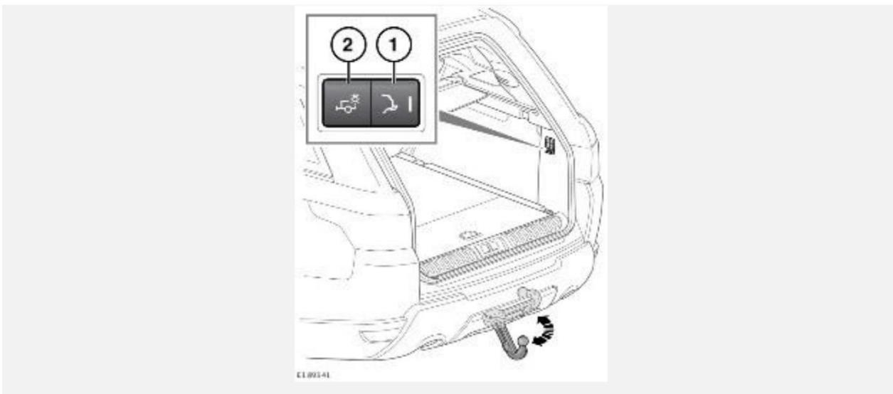
Сложить или разложить складную шаровую опору с электроприводом можно также при помощи кнопок, расположенных в багажном отделении.
