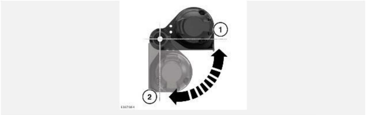
Разложите вручную электрический разъем (2), расположенный на тягово-сцепном устройстве. Электрический разъем (1) необходимо складывать после снятия съемной шаровой опоры тягово-сцепного устройства.
