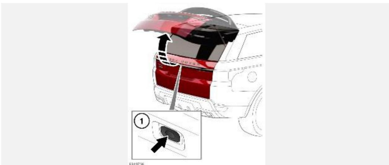
1. Наружная кнопка двери багажного отделения: нажмите для разблокировки, а затем поднимите дверь багажного отделения, чтобы открыть ее. Наружная кнопка двери багажного отделения сработает, если отперты все двери, а селектор передач находится в положении стоянки (P). Наружная кнопка двери багажного отделения
