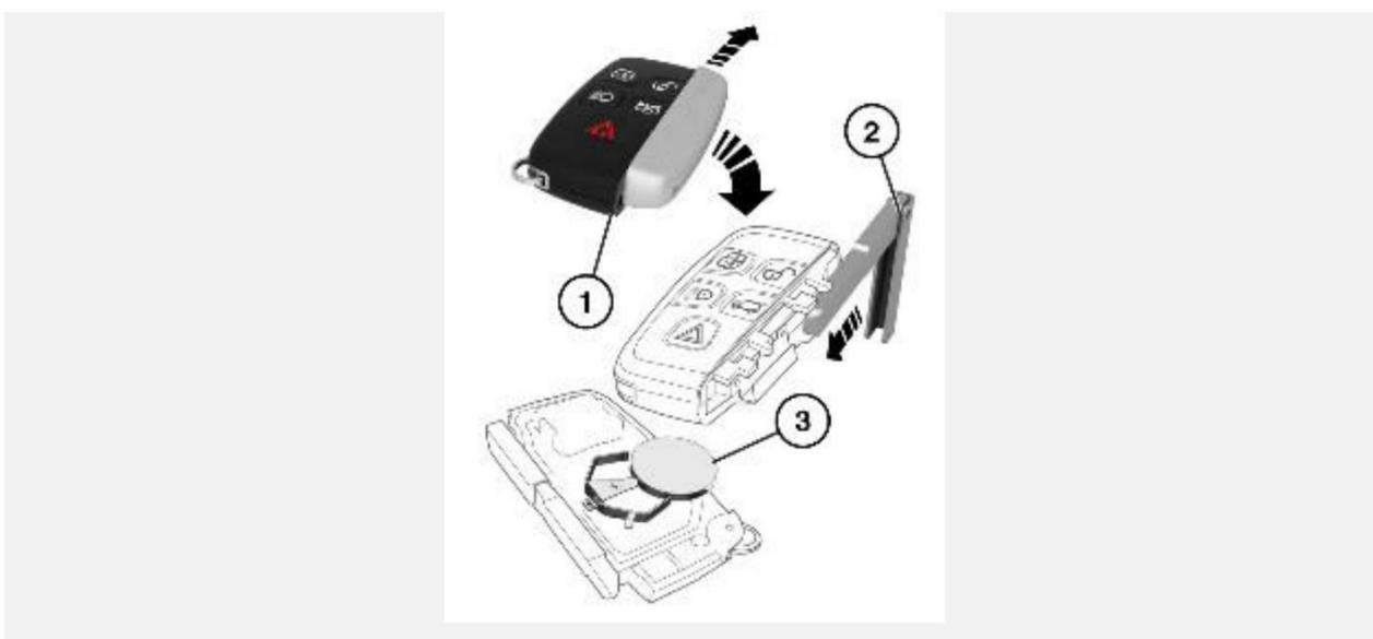
Уменьшение эффективного радиуса действия свидетельствует о необходимости замены элемента питания и сопровождается появлением на панели приборов сообщения **Smart Key Battery Low** (Разряжен элемент питания электронного ключа).
