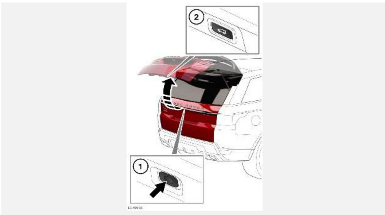
Чтобы задействовать дверь багажного отделения с электроприводом:
