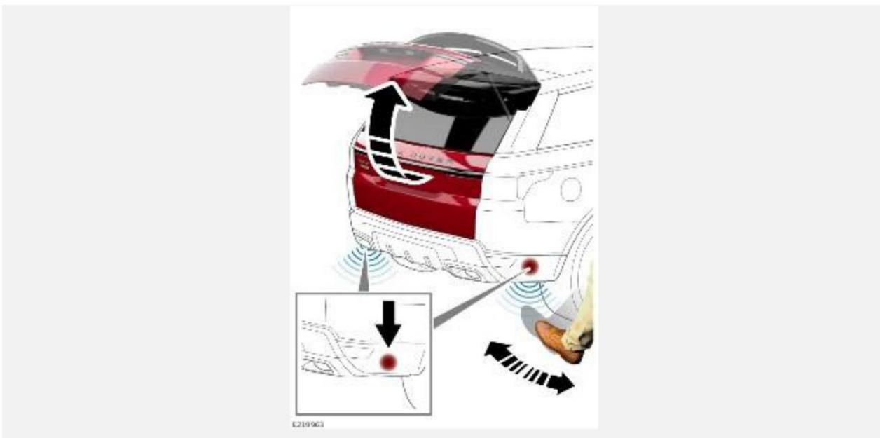
Чтобы активировать сенсорное бесконтактное открывание двери багажного отделения (движением ноги) подойдите к автомобилю и совершите плавное движение ног в прямом и обратном направлении. Движение ноги должно быть выполнено в течение 1-2 секунд в пределах одной из двух зон чувствительности датчиков автомобиля, как показано на рисунке. Как только автомобиль распознает движение, мигнут указатели поворота, и дверь багажного отделения работает.
