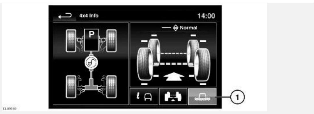
Систему определения глубины водного препятствия Wade Sensing также можно выбрать на экране **4X4** в меню **EXTRA FEATURES** (Дополнительные функции). См. [ГЛАВНОЕ МЕНЮ СЕНСОРНОГО ЭКРАНА](#).
