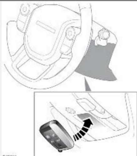
1. Рулевая колонка с электроприводом регулировки: приложите электронный ключ к боковой стороне рулевой колонки.
