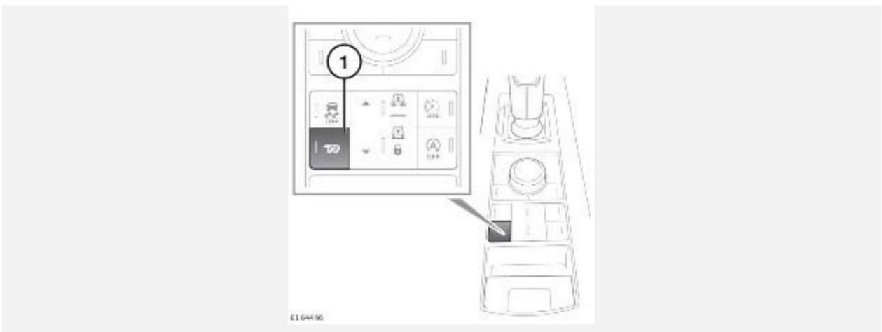
Функция активной выхлопной системы позволяет водителю изменить громкость и тональность звучания выхлопной системы. При запуске двигателя доступен один из трех режимов активной выхлопной системы: "Normal" (Нормальный), "Quiet" (Тихий) и "Dynamic" (Динамический).
