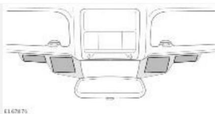
Атермальное ветровое стекло такого типа фильтрует солнечный свет, пропуская его через специальный слой внутри стекла.
