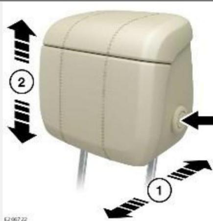
Регулировка положения подголовника: нажмите кнопку блокировки на боковой стороне подголовника. Одновременно с этим сдвиньте подголовник по горизонтали (1) и по вертикали (2), пока не будет достигнуто желаемое положение.
