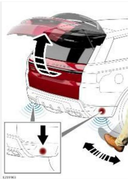
Чтобы активировать сенсорное бесконтактное открывание двери багажного отделения (движением ноги) подойдите к автомобилю и совершите плавное движение ногой в прямом и обратном направлении. Движение ноги должно быть выполнено в течение 1-2 секунд в пределах одной из двух зон чувствительности датчиков автомобиля, как показано на рисунке. Как только автомобиль распознает движение, мигнут указатели поворота, и дверь багажного отделения сработает.
