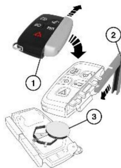
Уменьшение эффективного радиуса действия свидетельствует о необходимости замены элемента питания и сопровождается появлением на панели приборов сообщения **Smart Key Battery Low** (Разряжен элемент питания электронного ключа).
