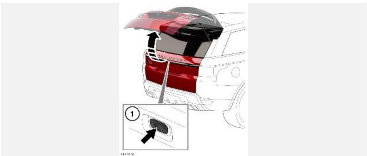
1. Наружная кнопка двери багажного отделения: нажмите для разблокировки, а затем поднимите дверь багажного отделения, чтобы открыть ее. Наружная кнопка двери багажного отделения сработает, если открыты все двери, а селектор передач находится в положении стоянки (P). Наружная кнопка двери багажного отделения
