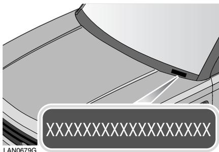
Номер VIN отштампован на пластинке, которая видна снаружи в левой нижней части лобового стекла (он должен совпадать с номером VIN, записанным в “Сервисной книжке”). VIN также может быть указан на следующих участках автомобиля: запорная платформа капота, стойка подвески и внутренние поверхности дверей.
