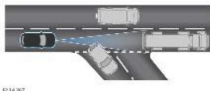
При выезде движущегося впереди автомобиля из полосы движения вашего автомобиля. Могут возникнуть проблемы с датчиком обнаружения в отношении того, за каким автомобилем необходимо следовать.
