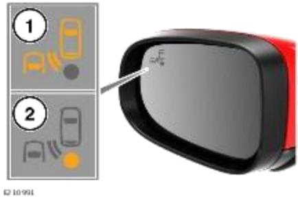
Система контроля "слепых" зон отслеживает зону рядом с автомобилем и примерно на 8,5 м позади него. Когда система обнаруживает идущий на обгон автомобиль, янтарная предупреждающая пиктограмма (1) выполняет следующее действие:
