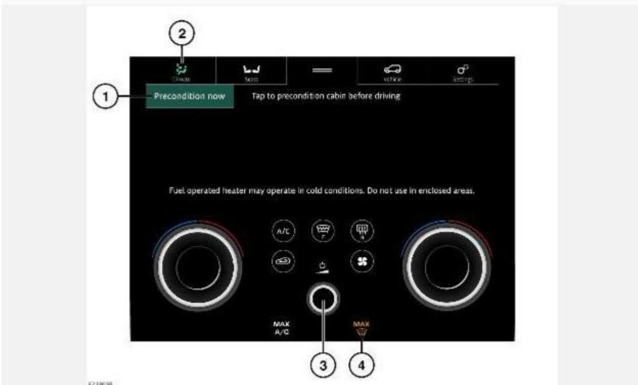
1. **Precondition now** (Выполнить предварительное кондиционирование сейчас): коснитесь для включения или выключения предварительного кондиционирования вручную с помощью нижнего сенсорного экрана.
