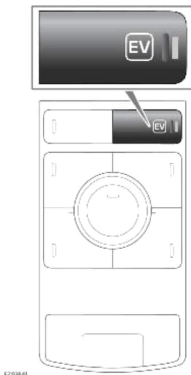
Чтобы включить режим электромобиля (EV), нажмите кнопку **EV**, расположенную на центральной консоли. В подтверждение выбора загорится светодиодный индикатор кнопки. В подтверждение выбора на панели приборов отображается сообщение **EV** (Электромобиль). См. [ПАНЕЛЬ ПРИБОРОВ: АВТОМОБИЛИ С ГИБРИДНЫМ ДВИГАТЕЛЕМ](#).
