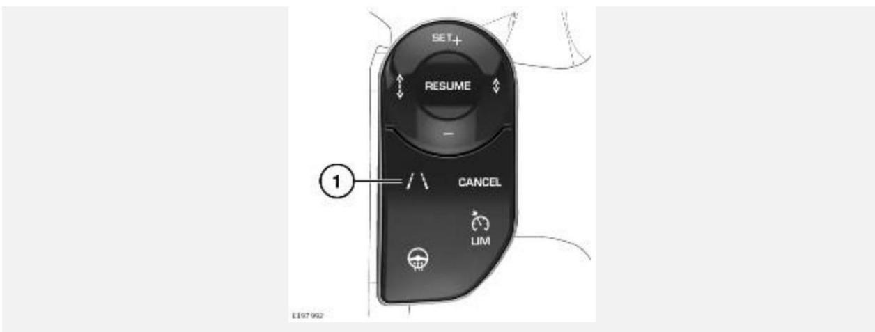
Для активации усилителя рулевого управления нажмите кнопку на рулевом колесе (1). Нажмите кнопку повторно, чтобы отключить функцию. Если функция включена, на панели приборов отображается состояние функции усиления рулевого управления.
