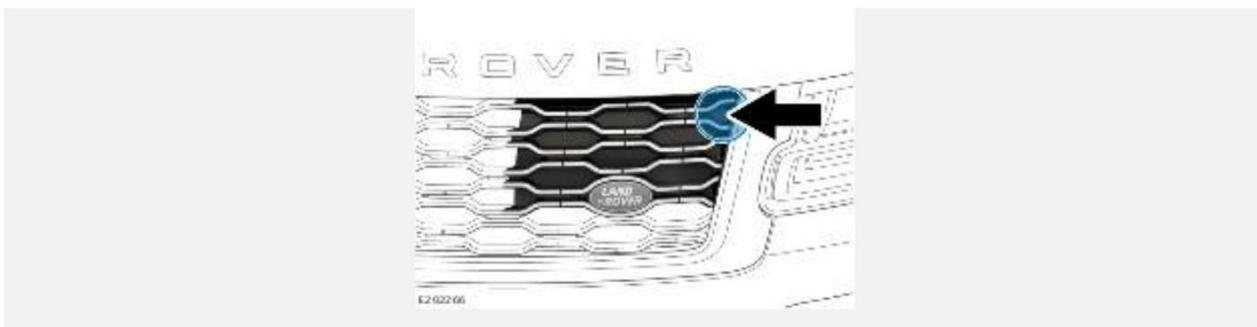
Разъем для зарядки расположен за решеткой радиатора. Чтобы получить доступ к разъему для зарядки, на незапертом автомобиле потяните за верхний правый угол решетки радиатора, как показано на рисунке выше. После этого сдвиньте крышку для получения доступа к разъему для зарядки.
