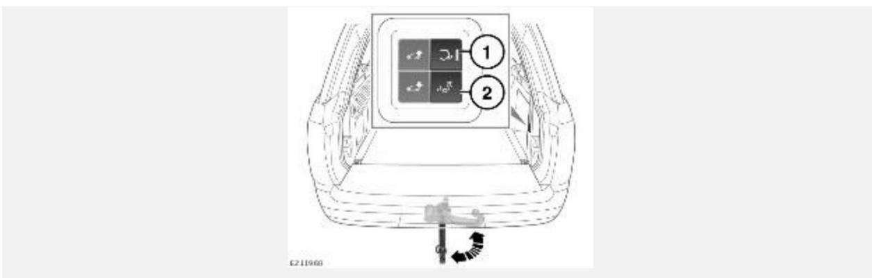
Сложить или разложить выдвижную шаровую опору также можно при помощи кнопок, расположенных в багажном отделении.
