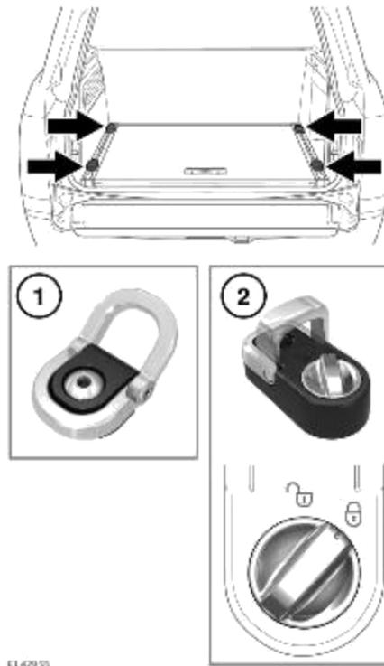
1. В полу багажного отделения находятся четыре проушины, позволяющие надежно закрепить крупный багаж.
