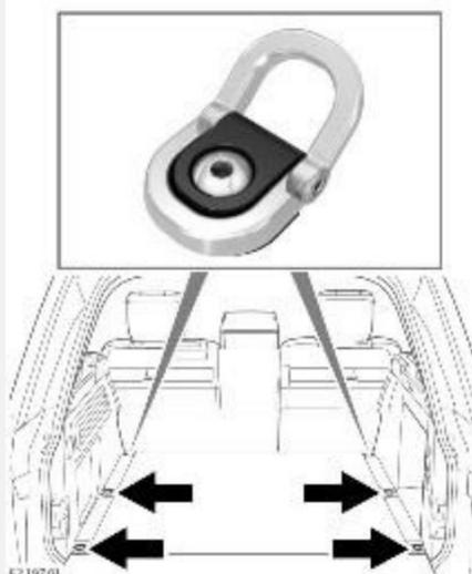
В полу багажного отделения находятся шесть проушин, позволяющих надежно закрепить крупный багаж.
