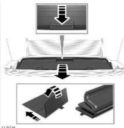
Чтобы получить доступ в багажное отделение из салона, сильно нажмите вниз на дальний край крышки, одновременно потянув ее к задним сиденьям. Крышка складывается, обеспечивая доступ к багажному отделению.
