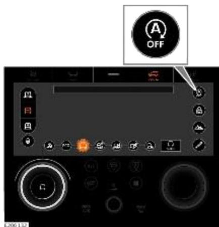
Коснитесь пиктограммы **A OFF** ("А" выкл.), чтобы отключить автоматическую интеллектуальную систему запуска/остановки двигателя "Стоп/Старт".
