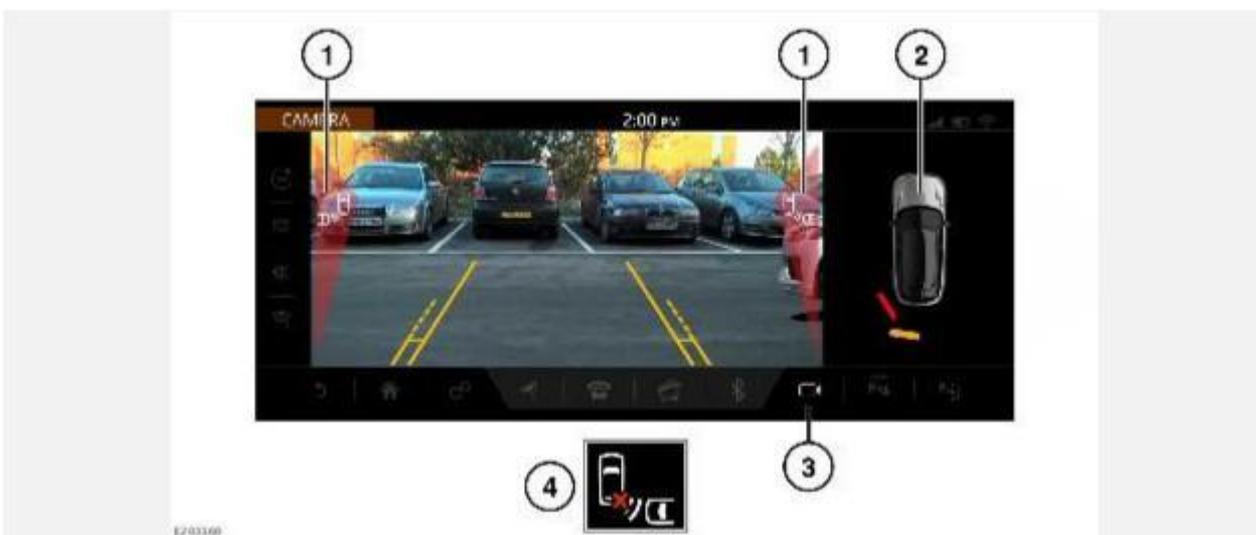
1. Предупреждающая пиктограмма **в виде автомобиля**: на экране **CAMERA** (Камера) или на экране **PARKING AID** (Система помощи при парковке) (в зависимости от текущего выбора) отображается предупреждающая пиктограмма **в виде автомобиля** с соответствующей стороны экрана. Пиктограмма **в виде автомобиля** оповещает о наличии движущегося автомобиля.
