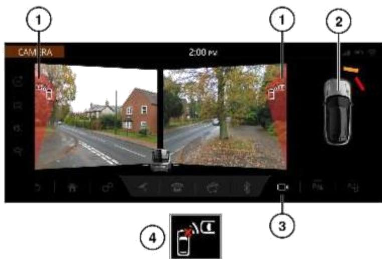
1. Предупреждающая пиктограмма **в виде автомобиля**: на экране **CAMERA** (Камера) или на экране **PARKING AID** (Система помощи при парковке) (в зависимости от текущего выбора) отображается предупреждающая пиктограмма **в виде автомобиля** с соответствующей стороны экрана. Данная пиктограмма оповещает о наличии движущегося автомобиля. Также подается звуковой предупредительный сигнал.
