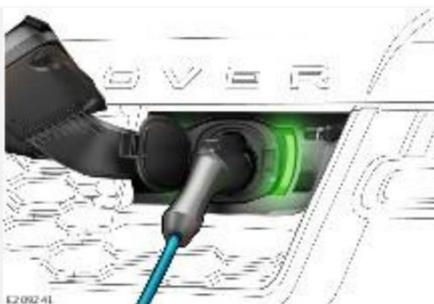
Светодиоды с каждой стороны разъема для зарядки информируют пользователя о состоянии зарядки. В определенных условиях светодиоды горят белым цветом, помогая подключить кабель для зарядки в условиях недостаточной освещенности.
