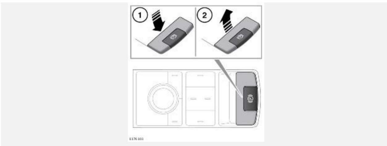
Переключатель EPB расположен на центральной консоли. Переключатель используется следующим образом:
