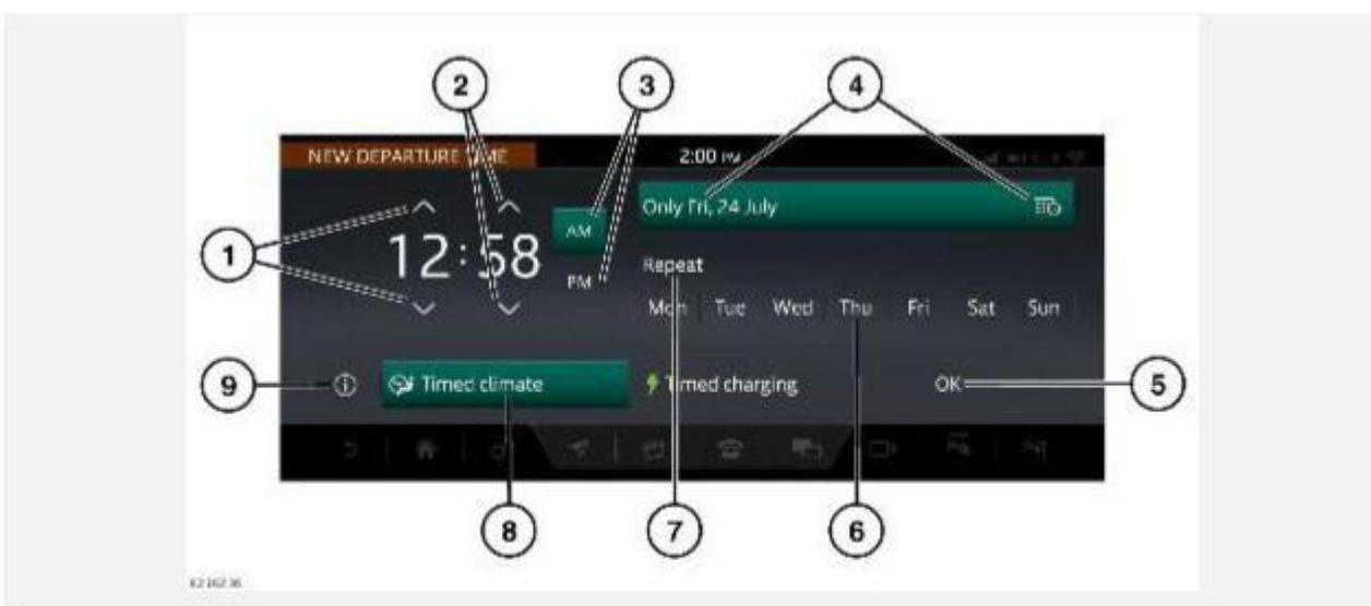
Для доступа к экрану **NEW DEPARTURE** (Новое время отправления) функции предварительного кондиционирования выберите день и время на экране **VEHICLE DEPARTURES** (Время отправления автомобиля). Нажмите программную кнопку **Timed Climate** (Климат-контроль с таймером).
