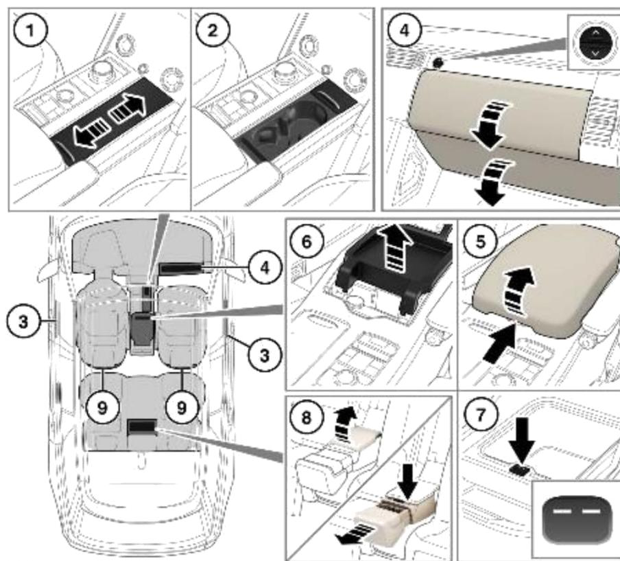
1. Подстаканники передних сидений: для получения доступа сдвиньте панель. Потяните панель, чтобы закрыть.
