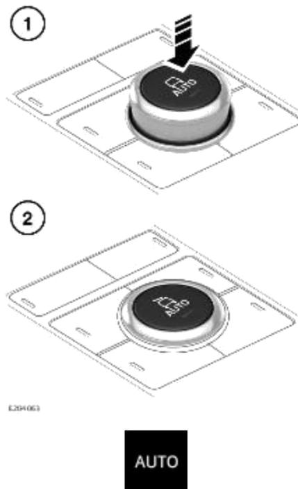
На некоторых автомобилях имеется программа вождения **AUTO** (Авто), которая автоматически определяет и выбирает соответствующую программу движения для текущих типа покрытия и условий движения.
