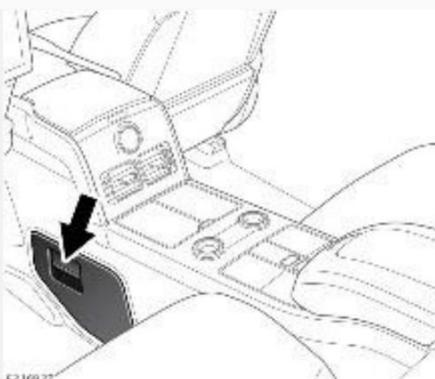
Потяните за ручку, чтобы разблокировать ящик для хранения, и сдвиньте ящик в сторону, чтобы открыть его. Ящик для хранения закрывается автоматически.
