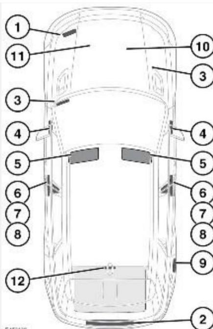
1. Платформа защелки капота — табличка системы кондиционирования воздуха (A/C).
