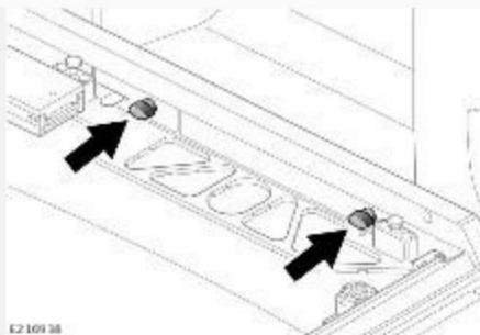
Поверните два крепления на правой направляющей в полу на 90°, чтобы освободить их из пружинного фиксатора. Освободив, снова поверните их на 90°, верните в горизонтальное положение и снимите с направляющей. Храните крепления в надежном месте.
