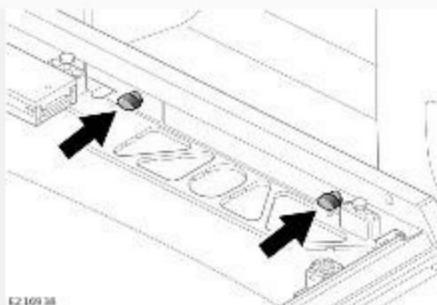
Удерживайте крепления в горизонтальном положении и сильно вдавите их в секцию направляющей. При фиксации пружинного зажима раздастся щелчок.
