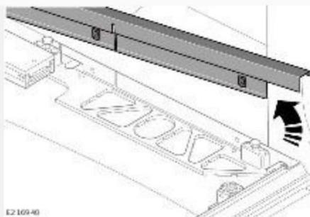
Поднимите съемную секцию направляющей и осторожно снимите ее с автомобиля.
