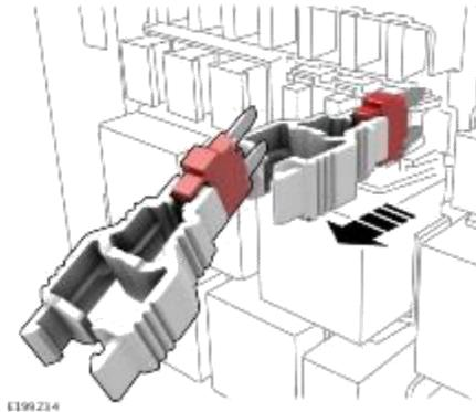
В случае прекращения работы электрической системы причиной может являться перегорание одного из предохранителей. Наиболее простым способом проверки предохранителя на наличие перегорания является его снятие.
