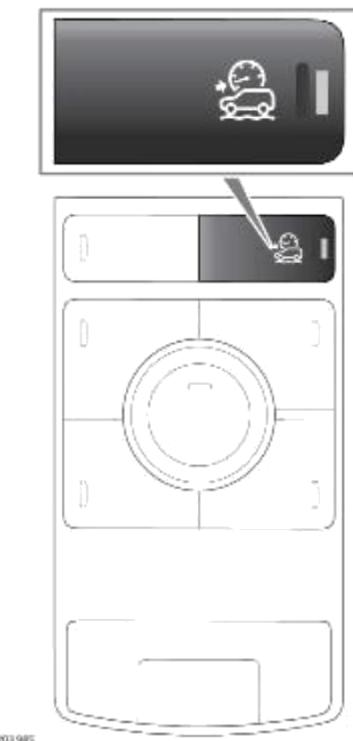
Чтобы включить систему ATPC, нажмите кнопку ATPC, расположенную на центральной консоли. На панели приборов отображается сообщение с рекомендацией задать скорость автомобиля. В подтверждение выбора загорается сигнализатор ATPC. См. [КРУИЗ-КОНТРОЛЬ НА НИЗКИХ СКОРОСТЯХ ПРИ ДВИЖЕНИИ НА РАЗЛИЧНЫХ ТИПАХ ПОВЕРХНОСТИ \(ATPC\) \(ЯНТАРНЫЙ\)](#).
