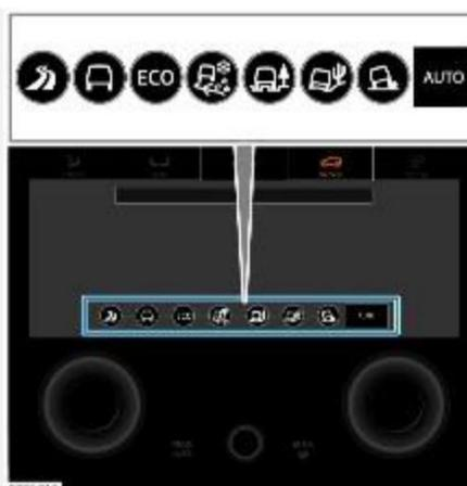
На нижнем сенсорном экране отображаются опции программ вождения системы адаптации к дорожным условиям Terrain Response.
