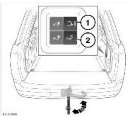
Сложить или разложить выдвижную шаровую опору также можно при помощи кнопок, расположенных в багажном отделении.
