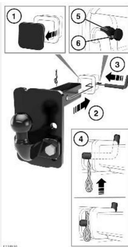
Чтобы установить буксировочное устройство с многопозиционной регулировочной пластиной:
