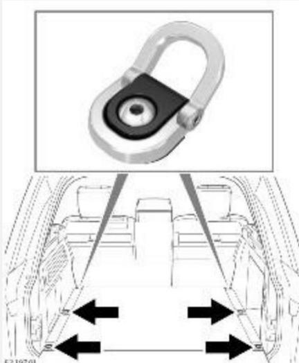
В полу багажного отделения находятся шесть проушина, позволяющих надежно закрепить крупный багаж.
