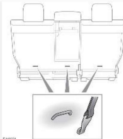
На автомобиле предусмотрены точки крепления , расположенные на задней части рам сидений второго ряда. Точки крепления следует использовать для установки лямок детских кресел или систем пассивной безопасности.
