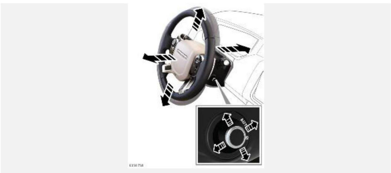
Перемещайте регулятор рулевой колонки вверх или вниз, чтобы отрегулировать угол наклона или высоту. Перемещайте регулятор рулевой колонки вперед или назад для регулировки по вылету. Поверните регулятор в положение **AUTO** (Авто) для автоматической работы. Поверните регулятор в положение ручной регулировки для ручного управления.
