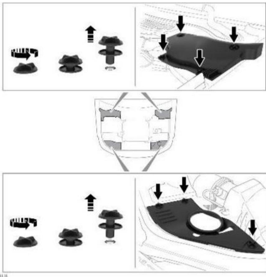
Следующие пункты описывают процедуру снятия крышки под капотом:
