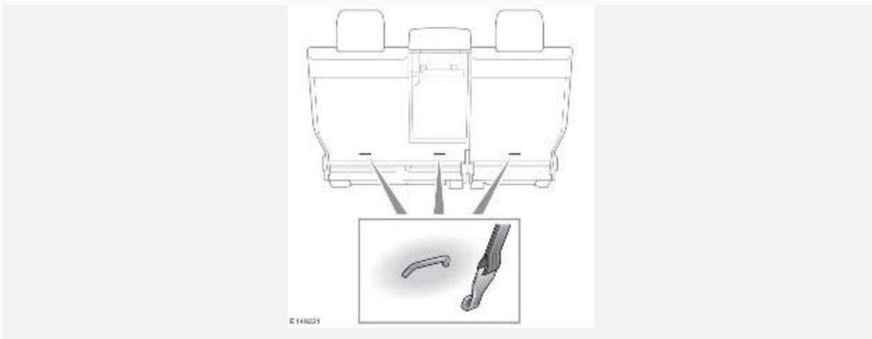
На автомобиле предусмотрены точки крепления, расположенные на задней части рам сидений второго ряда. Точки крепления следует использовать для установки лямок детских кресел или систем пассивной безопасности.
