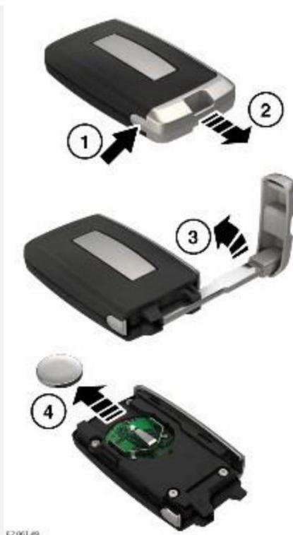
Уменьшение эффективного радиуса действия свидетельствует о необходимости замены элемента питания и сопровождается появлением на панели приборов сообщения **Smart Key Battery Low** (Разряжен элемент питания электронного ключа).
