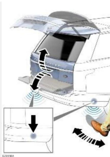
Датчики расположены в наружной части заднего бампера. Датчики распознают движение ноги ниже уровня бампера. Движение ноги обеспечивает автоматическое открывание или закрывание двери багажного отделения с электроприводом.
