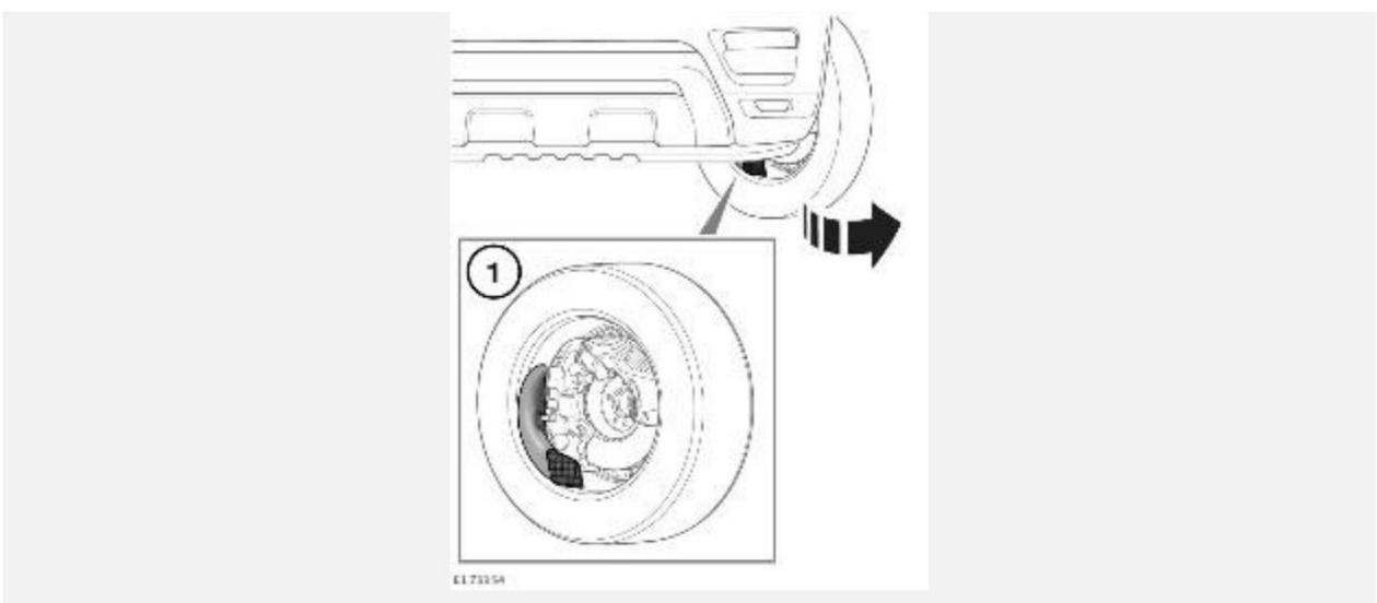
Автомобили Autobiography с бензиновым двигателем V8 (405 кВт) оснащены вентиляционными каналами тормозов на передних колесах. После езды по бездорожью обращайте особое внимание на данные участки. Проверьте вентиляционный канал (1) на предмет загрязнений. При необходимости можно использовать мойку под давлением.
