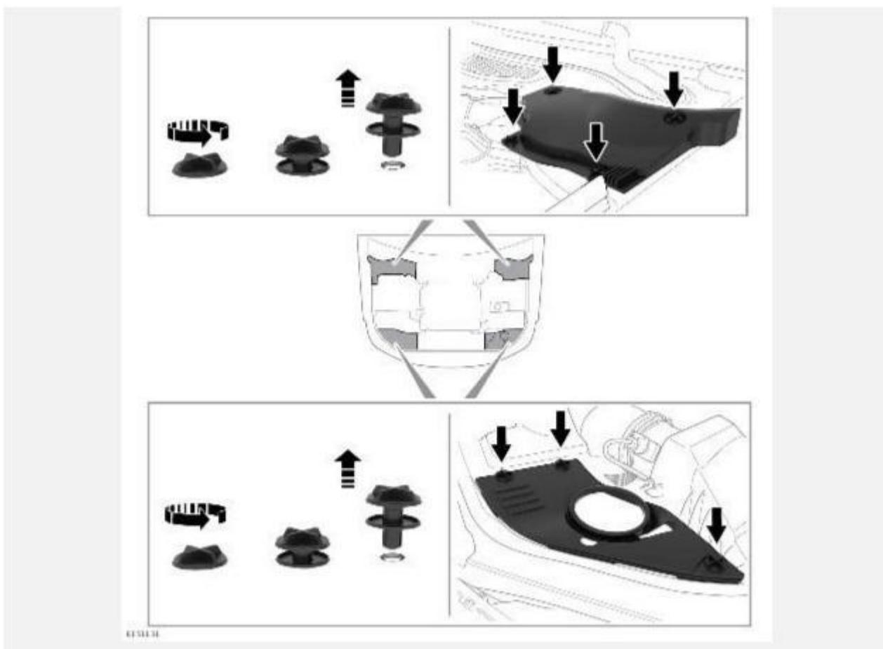
Следующие пункты описывают процедуру снятия крышки под капотом:
