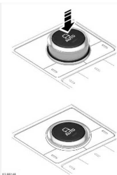
Некоторые автомобили оснащены автоматической программой движения (**AUTO**), которая определяет и выбирает наиболее подходящую к текущим условиям программу движения системы адаптации к дорожным условиям Terrain Response.
