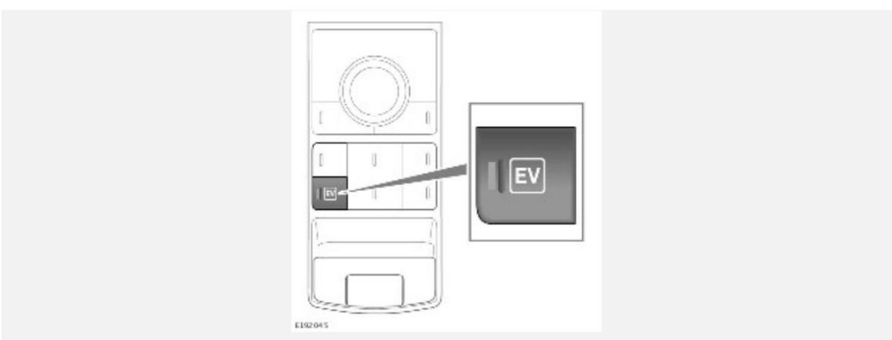
В режиме электромобиля (EV) автомобиль будет в максимально возможной мере использовать для движения только электродвигатель.
