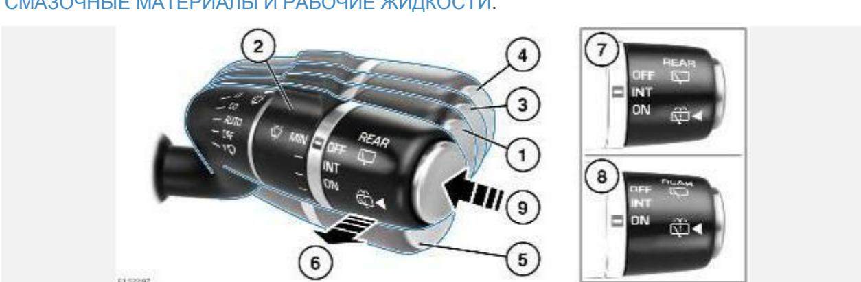
1. Режим автоматического обнаружения дождя: управление включением и скоростью работы щеток передних стеклоочистителей выполняется автоматически при наличии воды на стекле. При этом частота взмахов щеток выбирается в соответствии с преобладающими условиями. Чувствительность системы регулируется вращением кольца (2).
