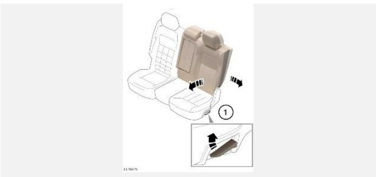
Чтобы отрегулировать угол наклона спинки сиденья:
