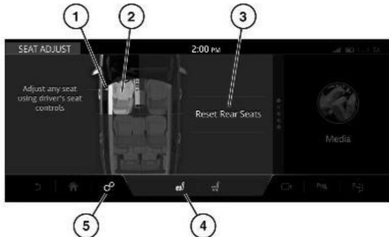
Положением сидений переднего и задних пассажиров можно управлять с помощью органов управления на водительском сиденье. Для выбора экрана удаленного управления сиденьями коснитесь пиктограммы настройки сидений, чтобы переключиться на экран **SEAT COMFORT** (Функции комфорта сидений) и экран **SEAT ADJUST** (Настройка сидений). См. [РЕГУЛИРОВКА И ФУНКЦИИ КОМФОРТА СИДЕНИЙ](#).
