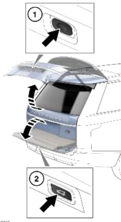
1. Кнопка открывания верхней секции двери багажного отделения: нажмите, чтобы открыть дверь багажного отделения. Поднимите дверь багажного отделения, чтобы открыть ее.
