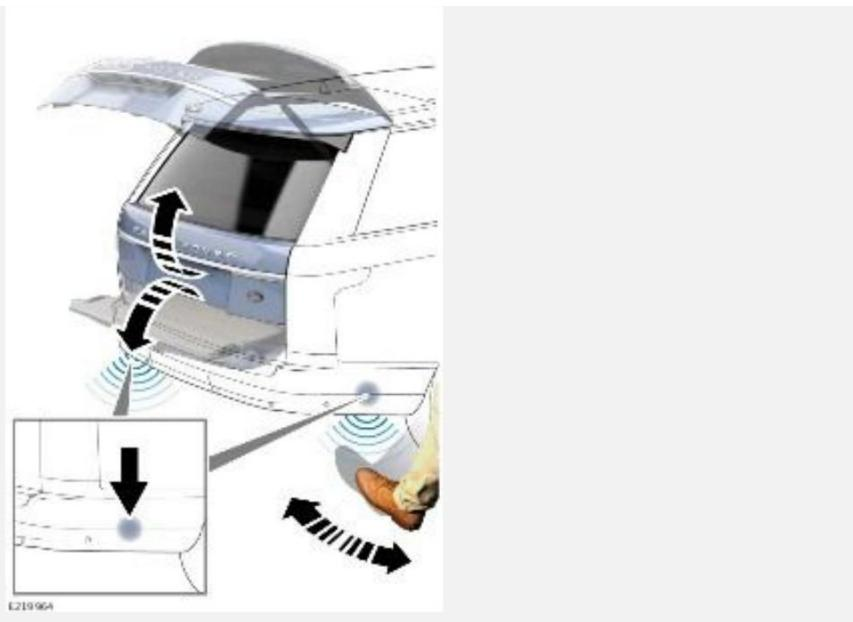
Датчики расположены в наружной части заднего бампера. Датчики распознают движение ноги ниже уровня бампера. Движение ноги обеспечивает автоматическое открывание или закрывание двери багажного отделения с электроприводом.
