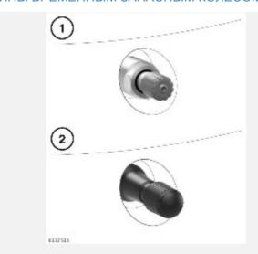
Колеса с системой TPMS можно отличить визуально по наружной металлической контргайке и ниппелю (1). На колеса всех автомобилей Land Rover, не оборудованных системой TPMS, ставятся обрезиненные ниппели (2).
