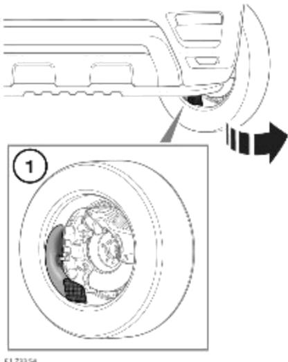
Автомобили Autobiography с бензиновым двигателем V8 (405 кВт) оснащены вентиляционными каналами тормозов на передних колесах. После езды по бездорожью обращайте особое внимание на данные участки. Проверьте вентиляционный канал (1) на предмет загрязнений. При необходимости можно использовать мойку под давлением.
