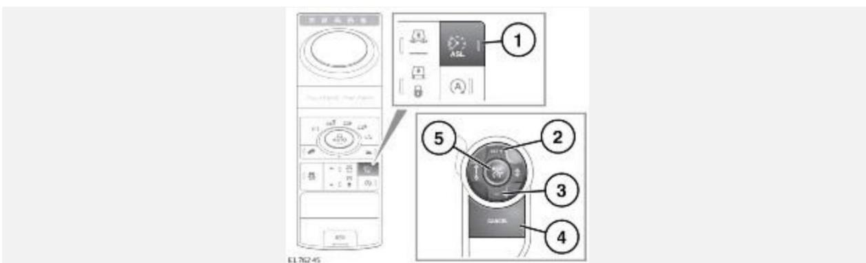
1. Включение/выключение ASL: данная кнопка ASL используется для переключения между круиз-контролем и ASL. Эти системы не могут использоваться одновременно. Индикатор ASL загорается при включении ASL. См. [АВТОМАТИЧЕСКИЙ ОГРАНИЧИТЕЛЬ СКОРОСТИ \(ASL\) \(ЯНТАРНЫЙ\)](#).
