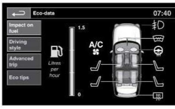
Система Eco-data помогает водителю максимально снизить расход топлива, предоставляя данные о системах автомобиля и советы по управлению. Доступ к системе Eco-data выполняется через меню **EXTRA FEATURES**(Дополнительные функции) сенсорного экрана. См. [ДОПОЛНИТЕЛЬНЫЕ ФУНКЦИИ](#).
