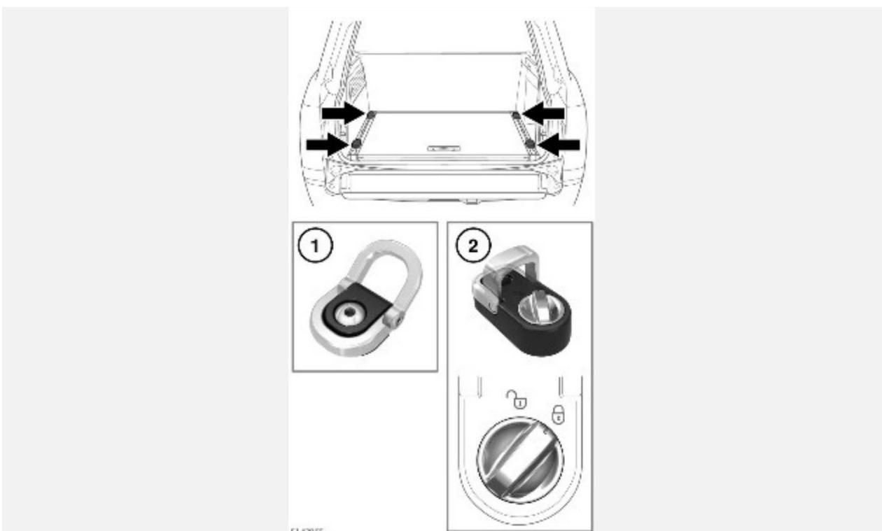
1. В полу багажного отделения находятся четыре проушины, позволяющие надежно закрепить крупный багаж.
