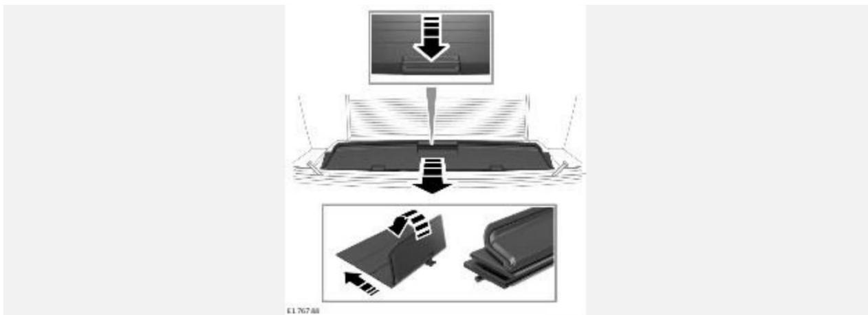
Чтобы получить доступ в багажное отделение из салона, сильно нажмите вниз на дальний край крышки, одновременно потянув ее к задним сиденьям. Крышка складывается, обеспечивая доступ к багажному отделению.
