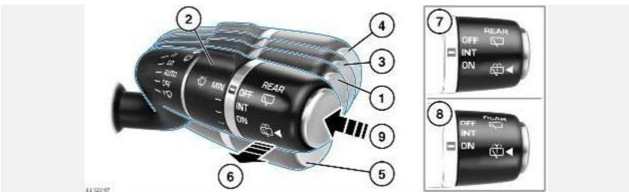
1. Режим автоматического обнаружения дождя: управление включением и скоростью работы щеток передних стеклоочистителей выполняется автоматически при наличии воды на стекле. При этом частота взмахов щеток выбирается в соответствии с преобладающими условиями. Чувствительность системы регулируется вращением кольца (2).
